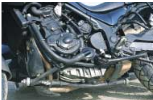
Für geringe Reaktionen bei Schräglagenwechsel sind die Kugelgelenke der Hilfsrahmen beider Maschinen niedrig angeordnet.
