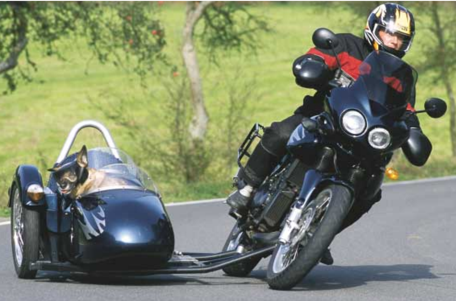
Große Enduros wie die Triumph Tiger taugen ideal für den Swing. In Links-kurven bestimmt nur die Reifenhaftung das Limit.
